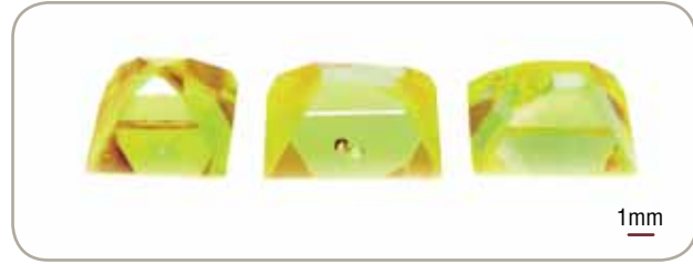
Кристаллы алмаза до отжига (слева), и те же кристаллы после отжига (справа)
