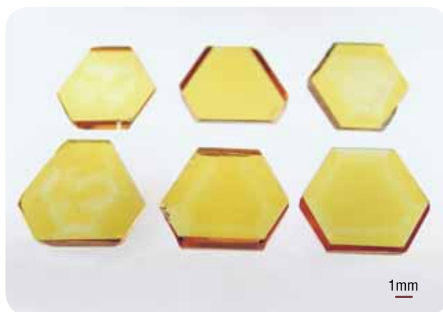
Элементы рентгеновской оптики из монокристаллов синтетического алмаза
