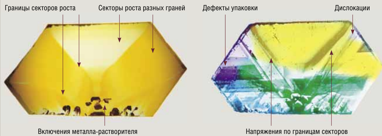
Пластинка, вырезанная из кристалла алмаза, в проходящем свете (слева) и рентгеновская топограмма той же пластинки (справа), позволяющая наблюдать распределение структурных дефектов
